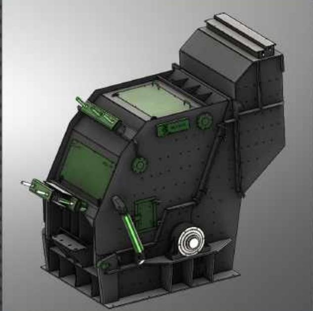
Orta sertlikteki ve silis oranı düşük olan malzemelerde yüksek kapasite ile çalışan, küçültme ve yuvarlaklaştırma oranı çok yüksek rotorlu kırıcılardır. Primer darbeli kırıcılar geneli kırıclara göre ürettiği ince malzeme oranının yüksek olması dolayısıyla tesisdeki sekonder kırıcı yükünü azaltmakta, bazı uygulamalarda gerek bile kalmamaktadır. Kırıcı tipine göre Max. 1000 mm ye kadar beslenebilmektedirler.
