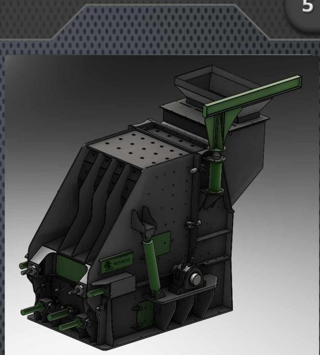
Açıklık ayarlı darbeli kırıcılardan olan USI serisi kırıcılar, orta ve yüksek sertlikte malzemeleri (kireçtaşı, dolomit, granit ve bazalt gibi) asfalt ve beton agregatı iriliğinde kırın kırıcılardır. İri malzeme beslenebilme, kübik ürün, yüksek küçültme oranı, yüksek kapasite, düşük yatırım ve işletme maliyeti bu tip kırıcıları, kırma eleme tesislerinde ideal sekonder kırıcı yapmaktadır.
